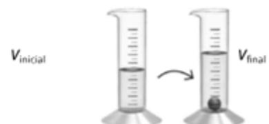
2- Regista o volume final da proveta com o berlinde dentro da proveta com água.
