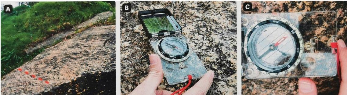
**Figura 6** – Determinação da direção de um plano. **(A)** Identificação da linha horizontal do plano (assinalada a tracejado). **(B)** Colocação da bússola paralela à linha horizontal. **(C)** Leitura da direção no anel de azimutes, após rotação.
