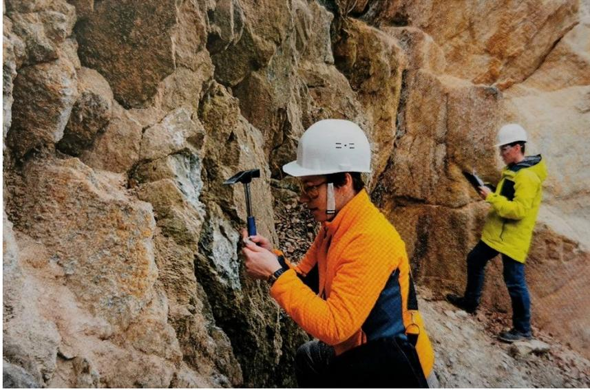
**Figura 13** – Equipamento de colheita de amostras em afloramentos (martelo, capacete e óculos de proteção). (Fonte: Odisseia, Geologia, Biologia e Geologia – 11.º Ano, Porto Editora)
